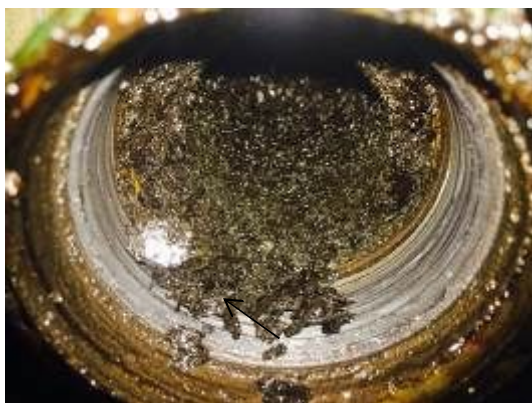
Рисунок 3 – Засорение механическими примесями плунжера ШГН
