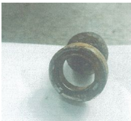
Рисунок 8 – Клапанная пара ШГН в отложениях солей и парафина
