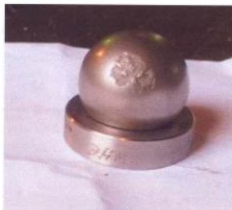
Рисунок 9 – Коррозия, раковины, сколы клапанной пары после работы в агрессивно-коррозионной среде
