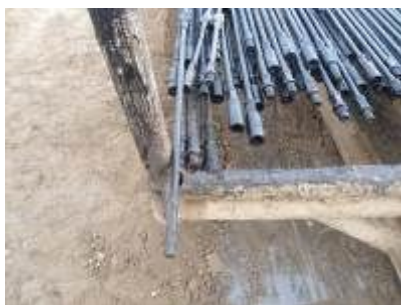
Рисунок 1 – Отложения парафина на штангах
