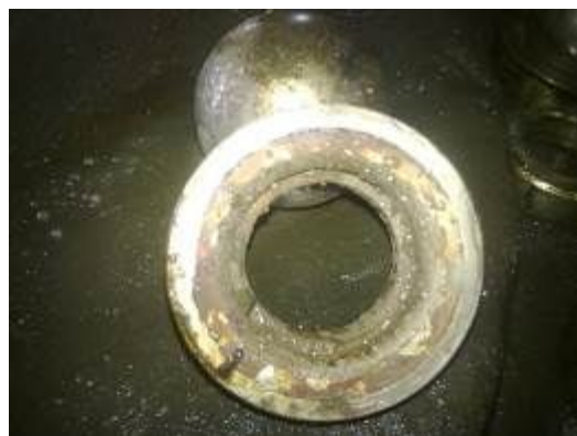
Рисунок 4 – Отложения твердых веществ серого цвета (соли) на внутренней поверхности седла всасывающего клапана
