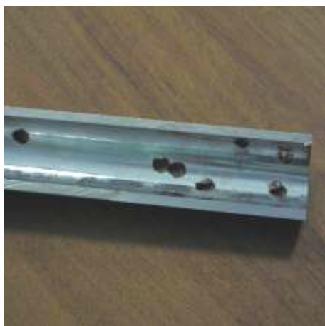
Рисунок 6 – Очаги коррозии основного металла внутренней поверхности цилиндра в результате процесса хромирования
